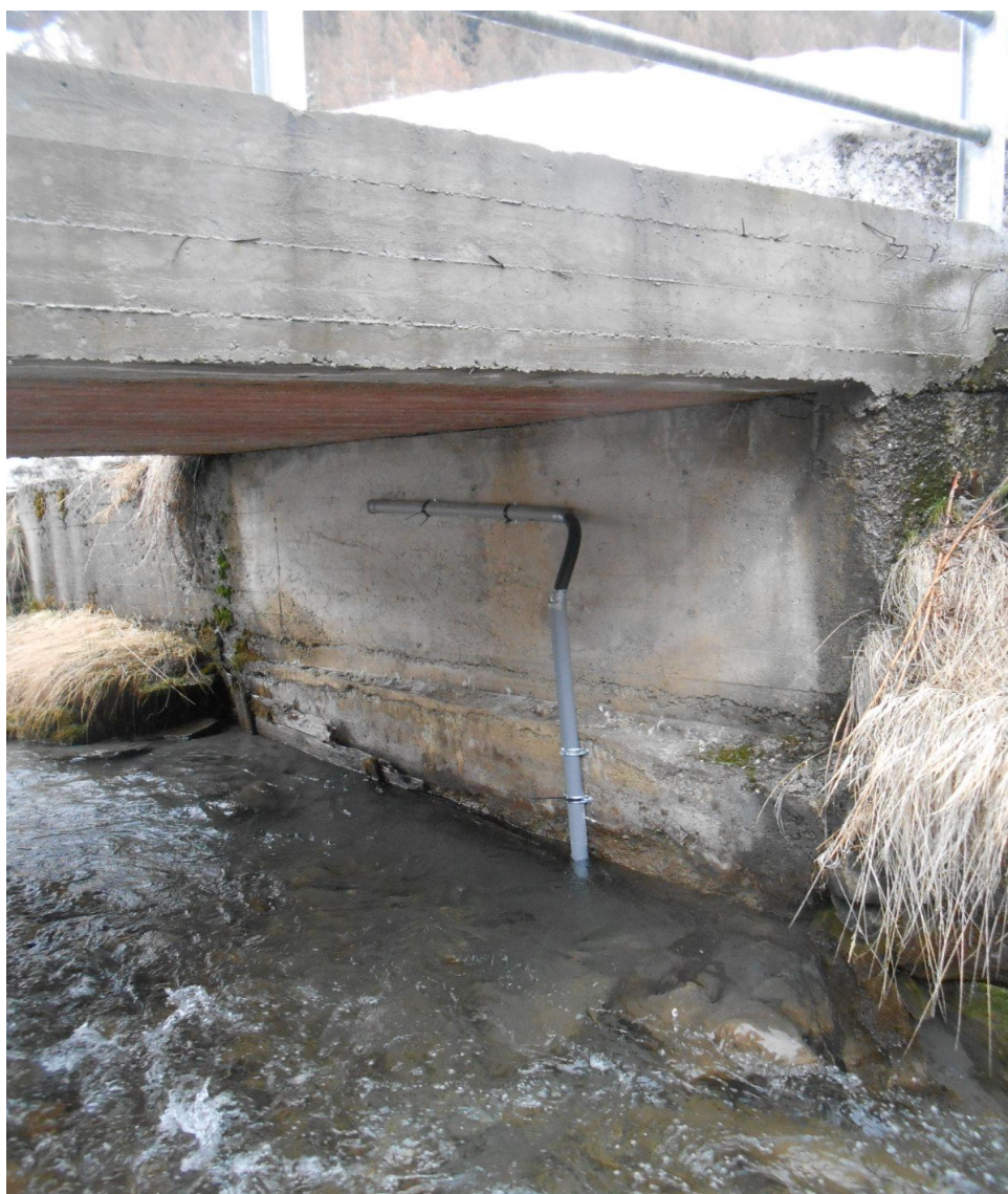
Figura 6: stazione di misurazione delle portate in continuo.
